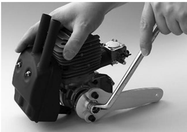
**Die Mutter mit 30 Nm (300 kpcm) anziehen.** ⚠ Das braucht schon einiges an Kraft oder einen „vernünftig“ langen Schlüssel. Aber selbst mit einem langen Schlüssel ist bei 20 cm Hebelarm immer noch eine Kraft von 150 N oder 15 kp aufzubringen.
