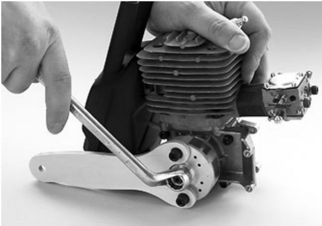
Um die Mutter zu lösen, verwenden Sie einen Ringschlüssel SW 14. Es ist ein „normales“ Rechtsgewinde M10x1. Also wie auf dem Bild zu sehen mit dem Schlüssel kräftig nach unten drücken.
