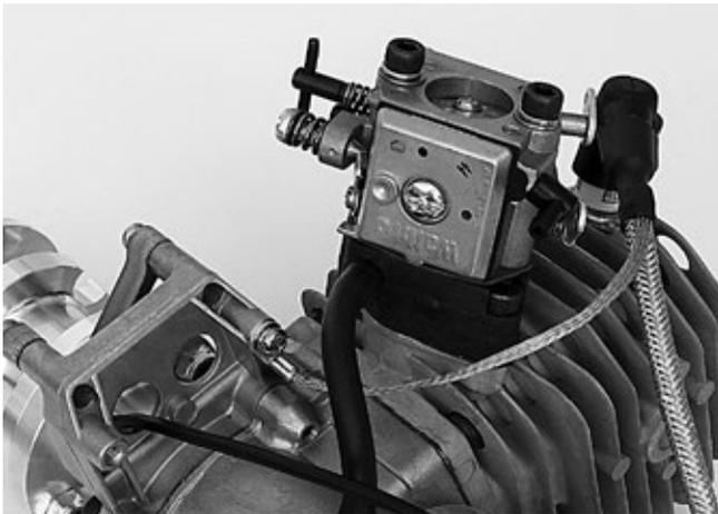
Am ZG 45 wird das Masseband an der Zündspulenhalterung am Kurbelgehäuse befestigt. Die Vergaserschrauben sind nicht geeignet, sie haben wegen des Vergaser-Isolierstückes keine leitende Verbindung mit dem Motorgehäuse.
