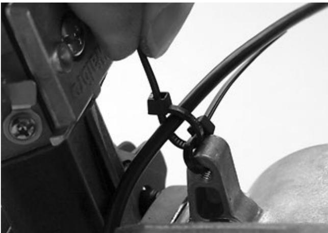
... und mit dem zweiten Kabelbinder das Sensorkabel am ersten Kabelbinder fixieren.
