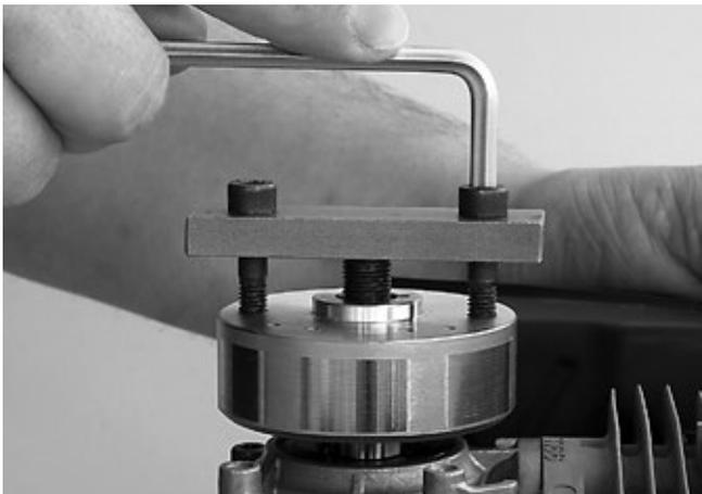
Mit dem Abziehwerkzeug und den zwei langen M6 Inbusschrauben kann jetzt die Schwungscheibe vorsichtig abgezogen werden.
