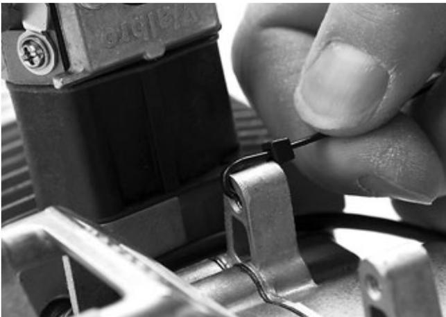
Mit den beiden Kabelbindern sollte das Sensorkabel abgefangen werden. Den ersten Kabelbinder wie hier gezeigt anbringen...
