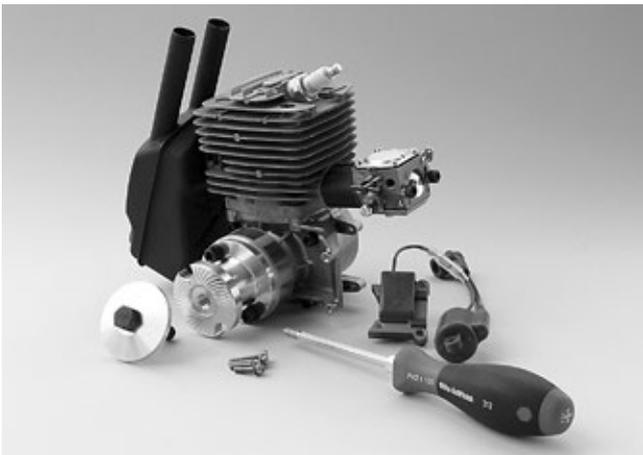
Die Zündspule und die Erregerspule der Magnetzündung abschrauben. Die Schrauben der Erregerspule bitte aufheben, wir brauchen sie später wieder.
