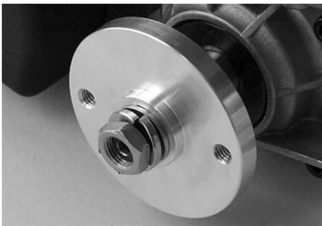
Wie vorher die Schwungscheibe wird auch der Adapter mit Scheibe, Federring und Mutter gehalten. Bitte kein Loctite verwenden! Das wäre sinnlos und würde nur eine spätere Demontage unnötig behindern. Der Federring sichert die Mutter absolut zuverlässig.
