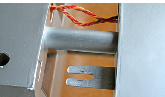
Ein Alurohr dient als Flächenverbinder. Die geschlitzte Lasche wird zusammen mit der Fläche in den Rumpf geschoben und anschließend durch eine Inbusschraube im Rumpf gesichert.
