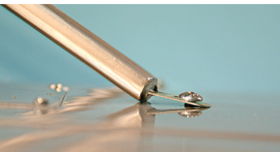
▲ ▼ An den Flächenstreben befinden sich Metalllaschen, die an der Fläche verschraubt werden sollen. Zusätzlich Balsaabschnitte auf den Laschen ergeben einen bessern Sitz und verhindern das Eindringen der Beplankung.
