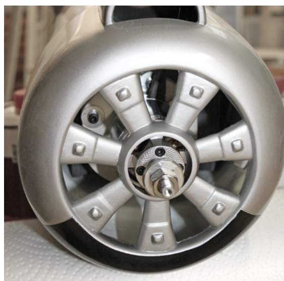
Mit Hilfe von Unterlegscheiben lassen sich Seitenzug und Sturz exakt einstellen.
