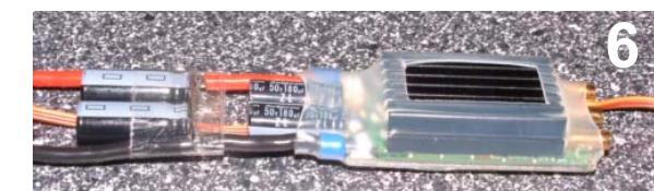
**6) Fixiere Akkukabel mit Sekundenkleber am Kondensatorgehäuse, Lötstelle mit Klebeband isolieren.**
