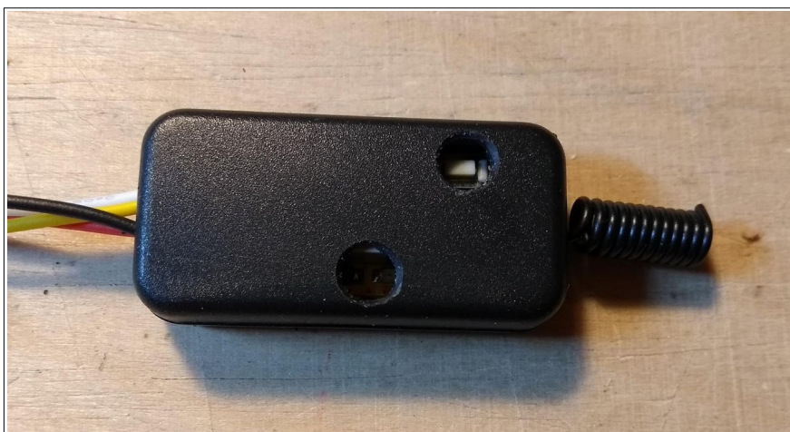
Bild 3: Der 433 MHz Empfänger im Gehäuse
