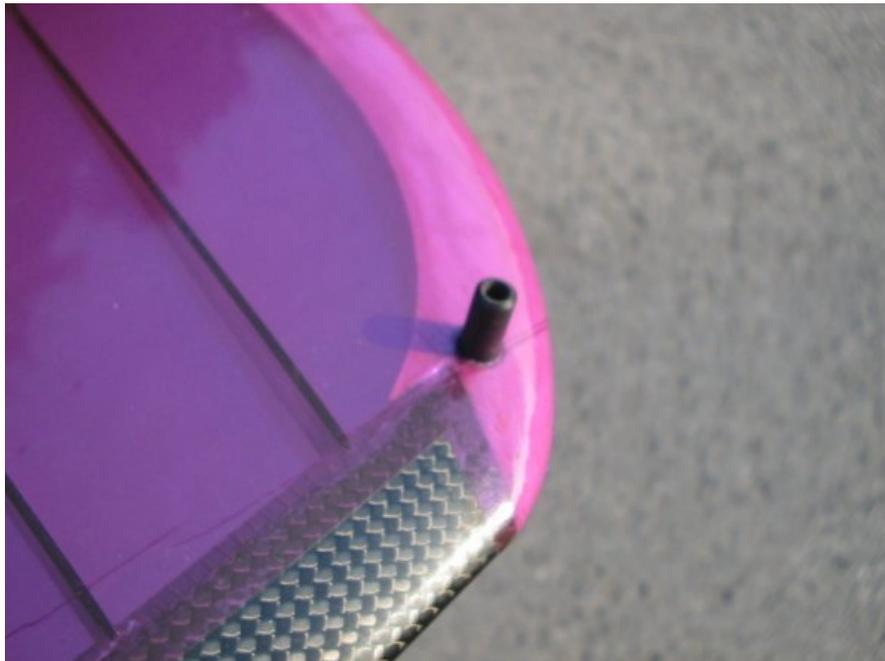
Den Stift so in die in der Tragfläche vorgesehene Bohrung einkleben, das dieser auf beiden Seiten ca. 2cm gleich weit heraus schaut.
