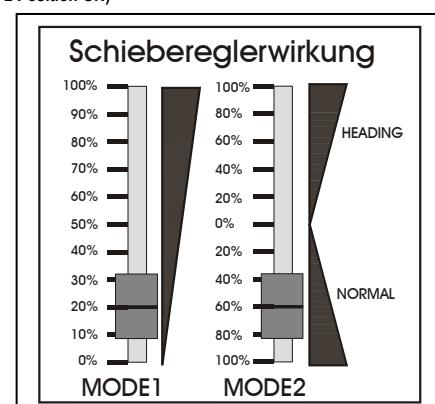
Als Lageposition wird die Lage angenommen, die beim Einschalten des Kreisels, beim Einschalten der HEADING-Funktion (Umschaltung von NORMAL auf HEADING-Betrieb) vorlag, oder die Lage/Position/Richtung, die nach Loslassen des Steuernußpels (Knüppel in Mittelstellung) neu eingenommen wurde.
