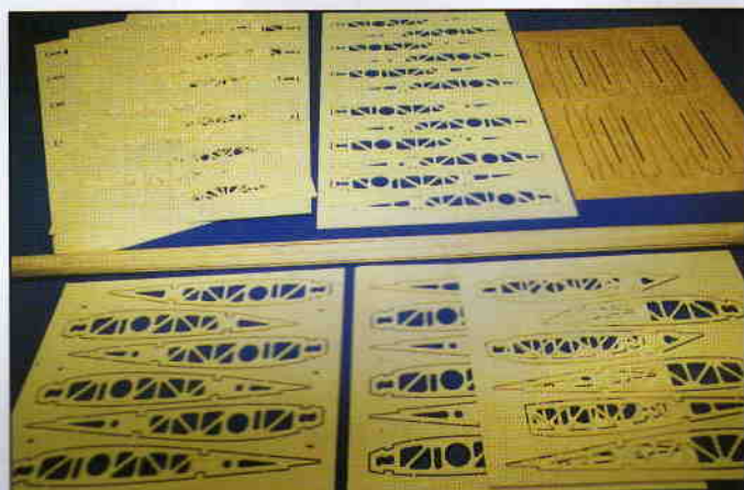
Sauber gefräst und übersichtlich angeordnet: die CNC-Frästeile für Rippen und ...
