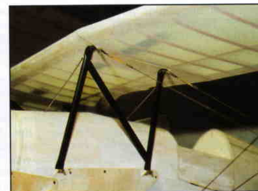
Neben der Verspannung sei hier auch auf das selbstklebende Zackenband auf jeder Rippe hingewiesen
