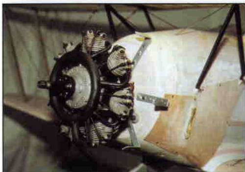
Er sollte es sein: Seidels Siebenzylinder ist nicht nur der Traum so mancher Modellfliegers, sondern er passt auch hervorragend unter die Haube
