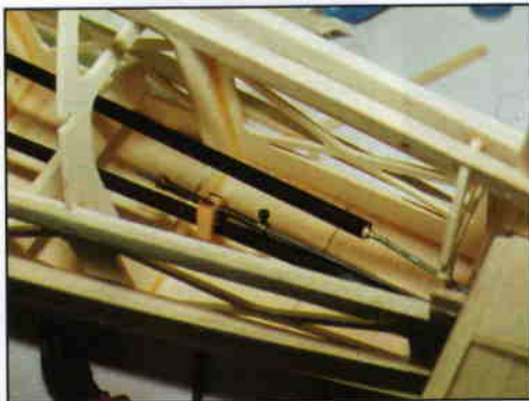
Die Anlenkung des Spornrads wird über einen Stahldraht und zwei Federn am Seitenruder-Gestänge kontrolliert
