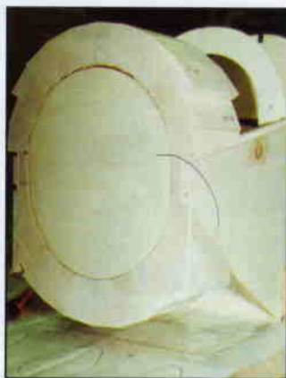
Wer will, kann nachzählen. Das Rumpfvorderteil besteht im Kern aus 26 Füllklötzen
