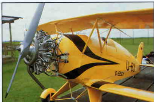
Während im Rohbau noch der »alte« Siebenzylinder Seidel ST 770 Platz nahm, ist seit kurzem der optisch brillante ST 710 mit von der Partie
