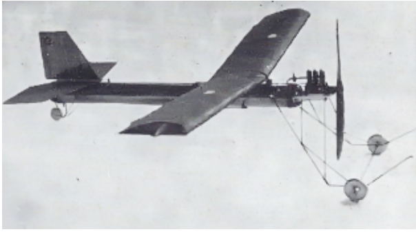
3-Zylinder Pressluftmotor-Apparat von Pause, ca. 1925 (Foto aus [1])
